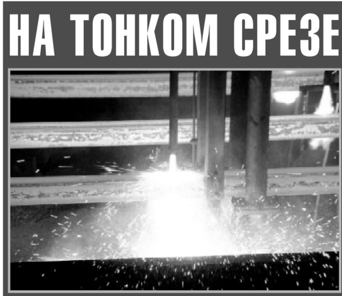
устранен человеческий фактор. Резка раскаленной заготовки проводится автоматически, в полном соответствии с заданными параметрами. Причем оператор при необходимости может их изменять, задавая нужную длину заготовки.
