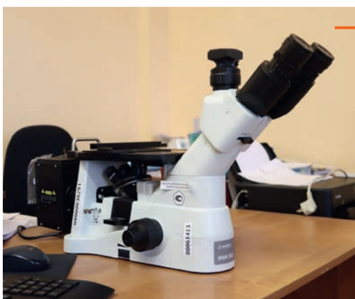
Комплекс аппаратно-программного анализа изображений NEXYS ImageExpert Sample 2
